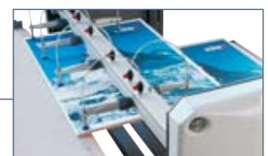
Automatische Zuführung von Bogen und Platten
